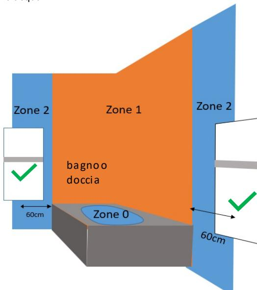
Il riscaldatore deve essere montato a parete solo in posizione verticale.
