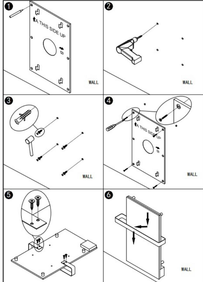
Schroef de vier afstandsstukken (in elke hoek) aan de achterkant van het verwarmingspaneel los, zodat het paneel stevig in zijn bevestiging aan de muur wordt vastgehouden en niet kan worden verschoven.
